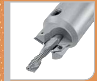
Kombinationswerkzeug mit Bohrgewindefräser M 12 2,5xD, IK Plansen- und Anfasplatte
