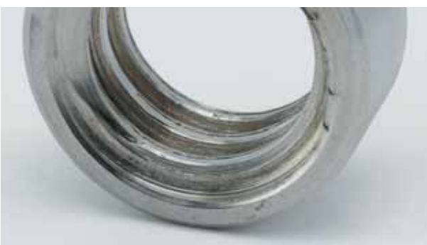
Mit Gewindebohrer geschnitten Machined with taps
