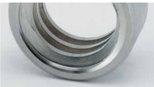
Mit GewindefräSer gefräSt Machined with thread milling cutter
