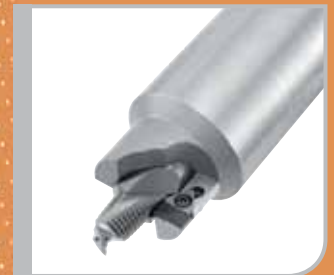
Kombinationswerkzeug mit Bohrgewindefräser M 16 x 1,5 stirnschneidig und einer PKD bestückten Konturplatte zur Bearbeitung einer vorgegossenen Bohrung
