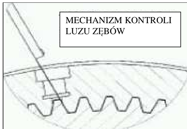
Rys. 5: Dwie ilustracje metody polegającej na użyciu narzędzia pomiarowego do pomiaru luzu
