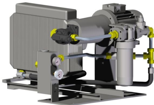
RYSUNEK 29. Chłodzony powietrzem układ smarowania ciśnieniowego.
