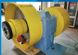
PRZEKŁADNIA DO NAPĘDU WALCA MASZYNY PAPIERNICZEJ
