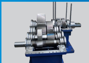
MONTAŻ PRZEKŁADNI PRZEMYSŁOWYCH
