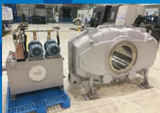
PRZEKŁADNIA DO NAPĘDU CYLINDRA YANKEE
