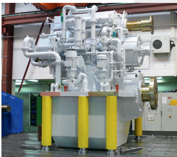
Przekładnia napędu głównego 14.400 kW i generator 10.000 kW
