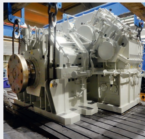
Przekładnia rębaka ; 2x2.300 kW
