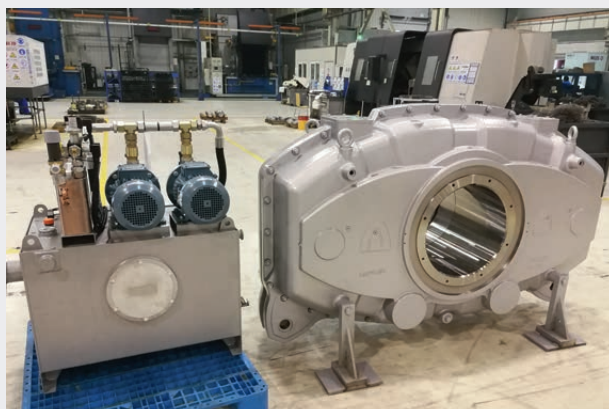
Przekładnia zębata Cumera do napędu cylindra Yankee.
