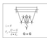
Fig. n.º 9. Twin hoist, 4 sheaves. Double line to drum.
