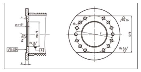
Fig. n.º 12. Cable drum flange details.
