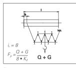
Fig. n.º 11. Hoist, 4 sheaves. Single line to drum.
