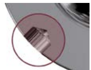
Wuchten durch Anbringen von Ausgleichsbohrungen Beispielrechnungen und Detailskizze auf der nächsten Seite.
