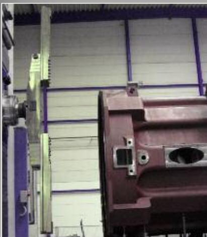
Fertigbearbeitung eines Gussgehäuses GG 25: Ø 870 HT , V c 400 m/min., Bearbeitungslänge 1700 mm, Schneidstoff WBN 300, Bearbeitungszeit: 103 Min.
