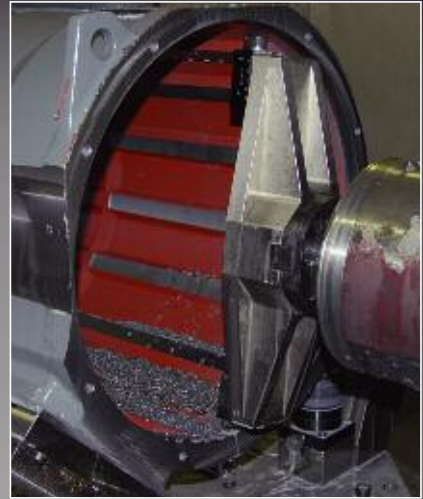
Statorgehäuse GGG 50: Vor-/Fertigbearbeitung Combi-Line Ø 409,5 PT , Bohrungstiefe: 500 mm, stark unterbrochener Schnitt
