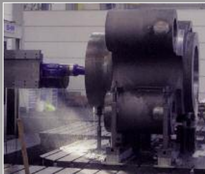
Fertigbearbeitung eines Gussgehäuses GG 25: Ø 870 HT , V c 400 m/min., Bearbeitungslänge 1700 mm, Schneidstoff WBN 300, Bearbeitungszeit: 103 Min.
